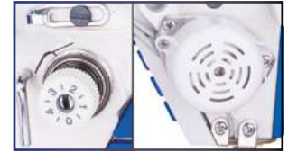
Yeni tasarım elektronik iplik tansiyonu diski ile muadillerine göre etkin performans sağlar.
