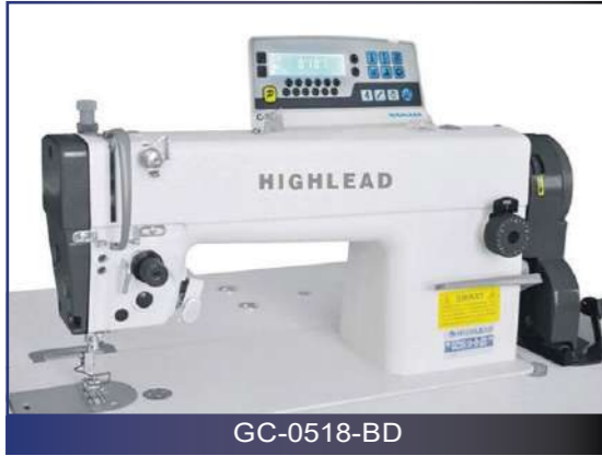
Elektronik İplik Kesmeli Yüksek Devirli İğne Transportlu Kilit Dikiş Makinesi (Büyük Mekik)
