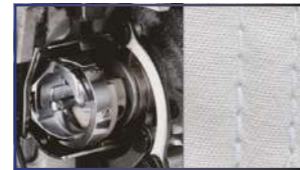
Çift yuvarlak bıçak mekanizması ile 3mm'de kısa iplik uçları yapılabilir ve işçilerin iş yükü önemli ölçüde azaltılabilir.
