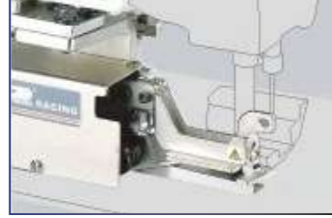
TC M-L25/F Sipariş Rehberi 1: Biye Kesim Yolu M: Manuel Kesim Pedalı
